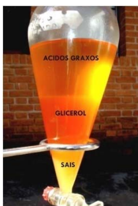
Figura 2. Separação da glicerina: a fase superior corresponde a ácidos graxos; a fase intermédia a glicerol; e a fase inferior, glicerol + sais (Fonte: adaptado de Rivaldi et al., 2008).
